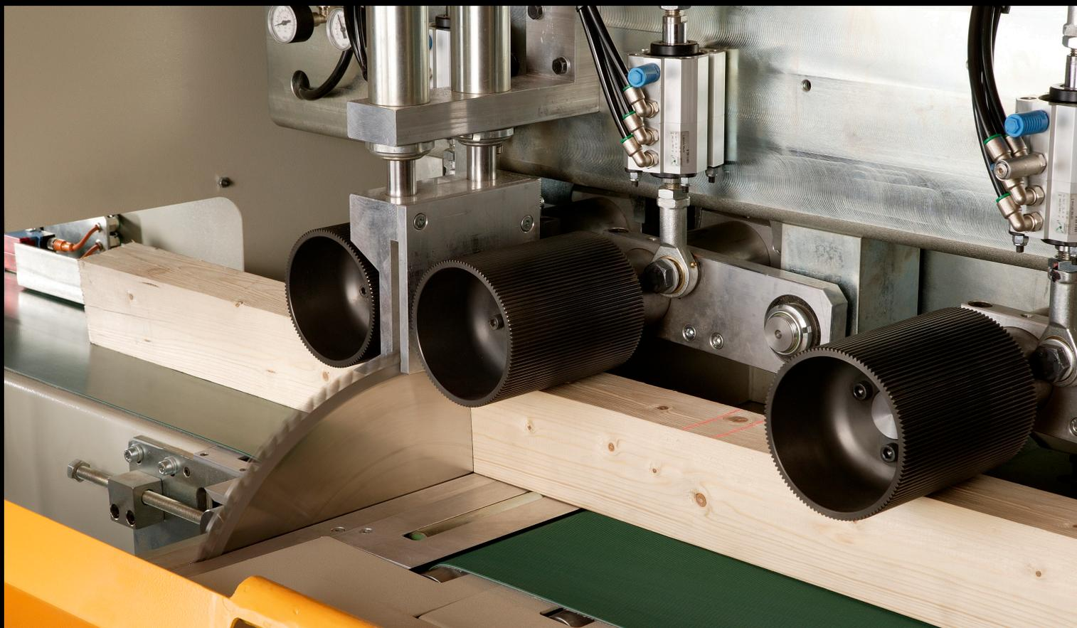
*Sistema integrale di trazione: il doppio sistema di avanzamento del pezzo in lavorazione avviene nella parte inferiore tramite un nastro di avanzamento ad alta aderenza mentre nella parte superiore tramite rulli dentati che si adattano perfettamente al legno, favorendo così il corretto avanzamento anche di tavole grezza, non piane.*
