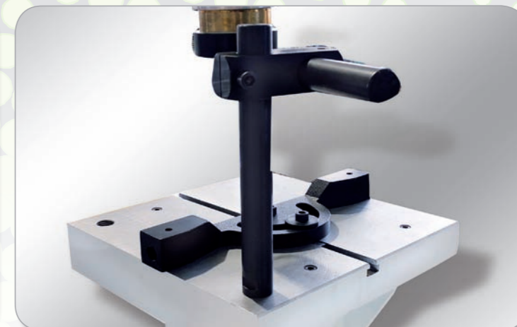
Tavolo di lavoro fisso con piano in ghisa per lavorazioni di testa • Dimensioni: 350 x 350 mm • N.1 Pressore di bloccaggio verticale completo di registro appoggia pezzo
