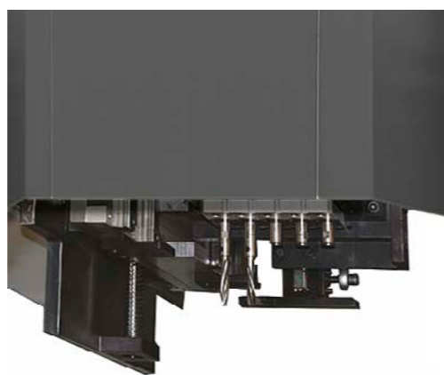
Unità a forare punto a punto con cinque mandrini indipendenti e pressore integrato Point to point drilling unit with five independent spindles and integrated clamp
