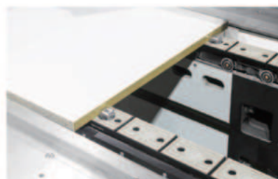
重型坦克链定位规方装置 Heavy-duty tank chain stop cams device
