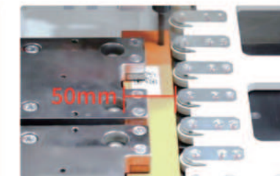
最小加工尺寸: 50mm Min. processing dimension: 50mm
